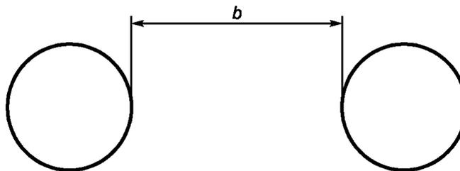
$b$  - расстояние между кромками двух отверстий, не менее  $2s$ , мм ( $s$  - номинальная толщина стекла, мм)
