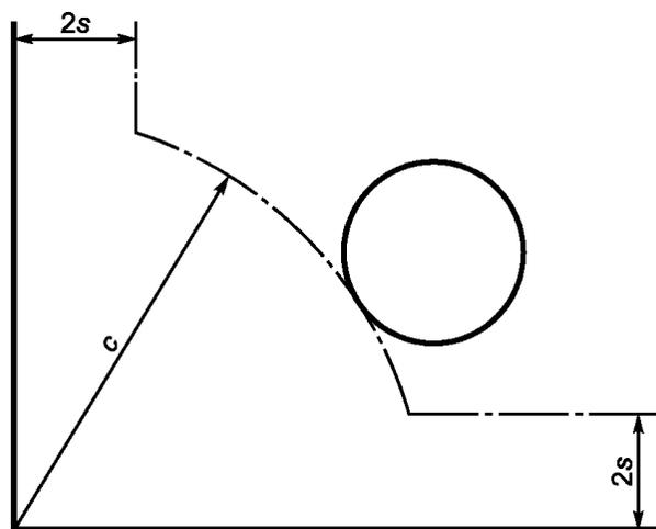
$c$  - расстояние от угла листа стекла до кромки отверстия, не менее  $6s$ , мм ( $s$  - номинальная толщина стекла, мм)
