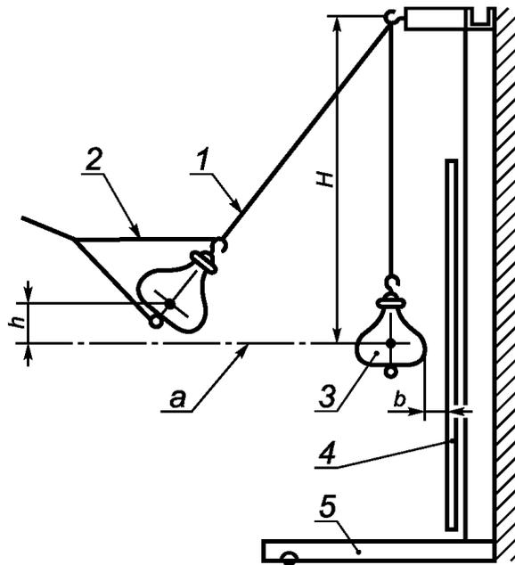
1 - стальной трос диаметром 2,5 - 4 мм; 2 - уздечка для подъема мешка; 3 - кожаный мешок (мягкое тело); 4 - испытуемый образец; 5 - опора; H - высота подвеса; h - высота падения мешка; a - центральная ось испытуемого образца; b - расстояние между образцом и мешком, висящим в свободном состоянии
