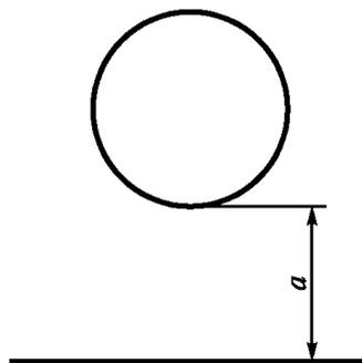
$a$  - расстояние от кромки стекла до кромки отверстия
