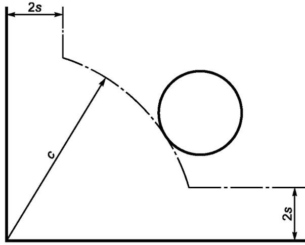
s - расстояние от угла листа стекла до кромки отверстия не менее 6s, мм (s - номинальная толщина стекла, мм)
