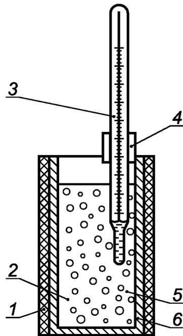
1 - теплоизоляция; 2 - ацетон или изопропиловый спирт;
