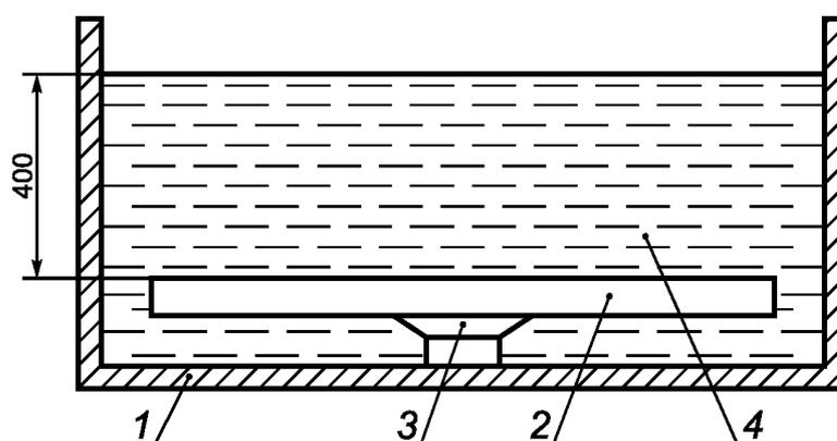
1 - емкость с водой; 2 - образец стеклопакета;
